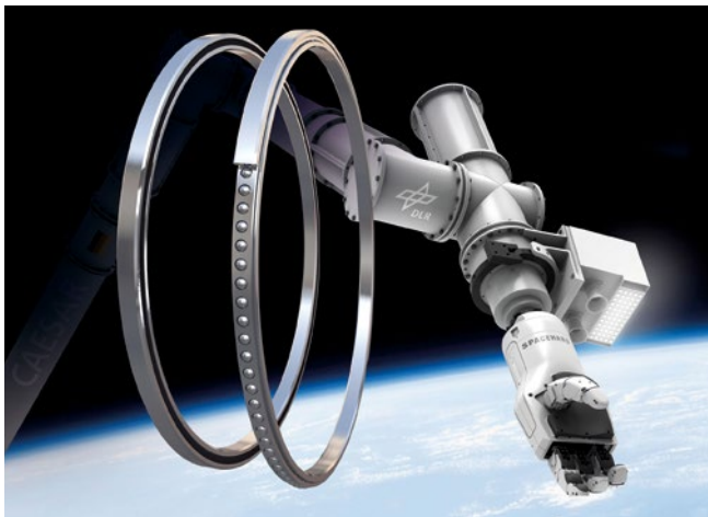
In der Roboterhand Caesar sind Dünnringlager verbaut, die besonders effizient sowohl Radial- als auch Axialkräfte aufnehmen können und dabei besonders raumsparend sind.
