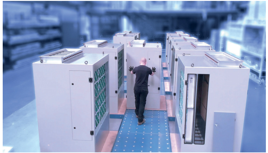
Bild 2: Aufgrund des kleinen Reibungswiderstands ist mit Kugelrollen der einfache und präzise Transport auch schwerer Stückgüter in alle Richtungen möglich. Foto: Always Engineering
