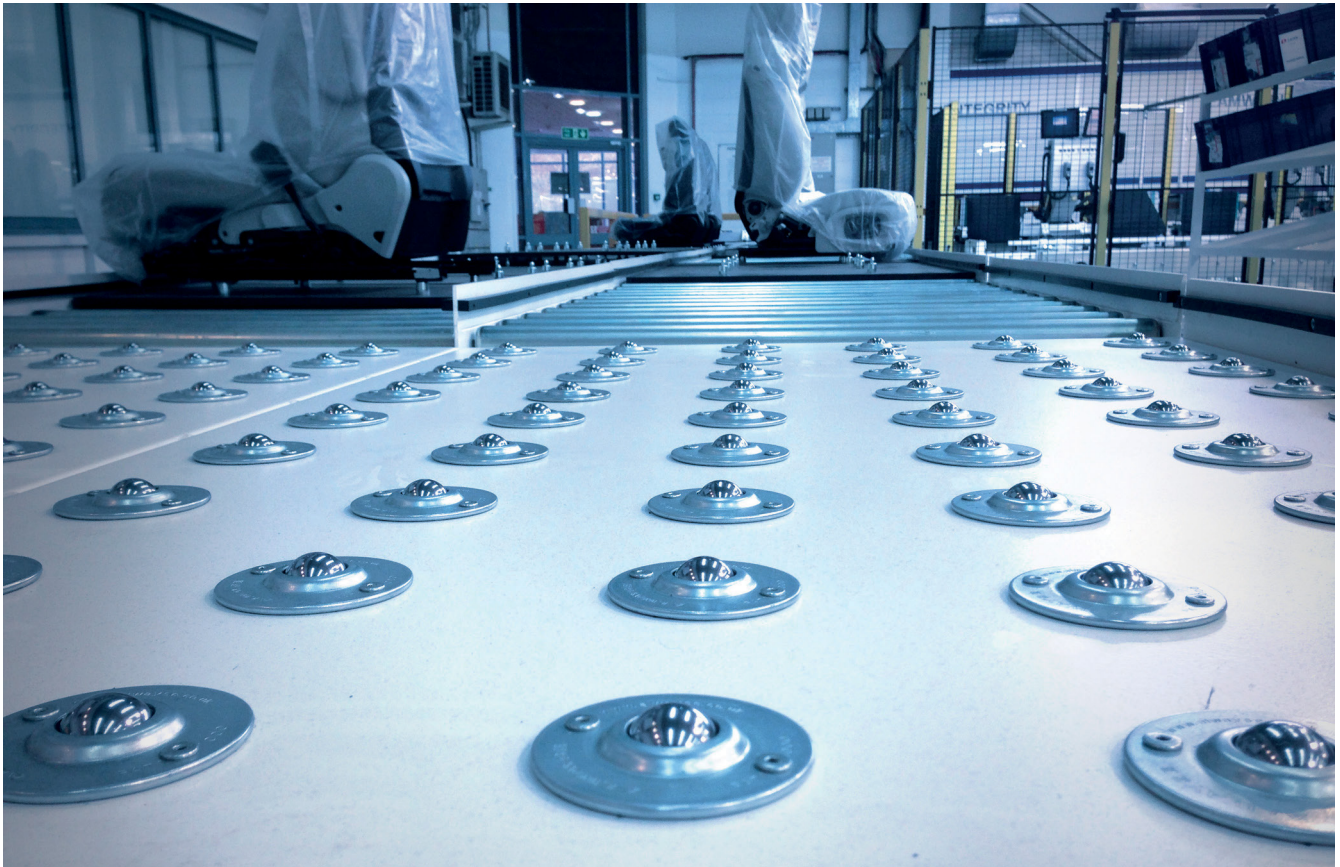
Bild 1: Kugeldecks mit Air Cargo Units haben eine sehr hohe Tragfähigkeit. Foto: Always Engineering
