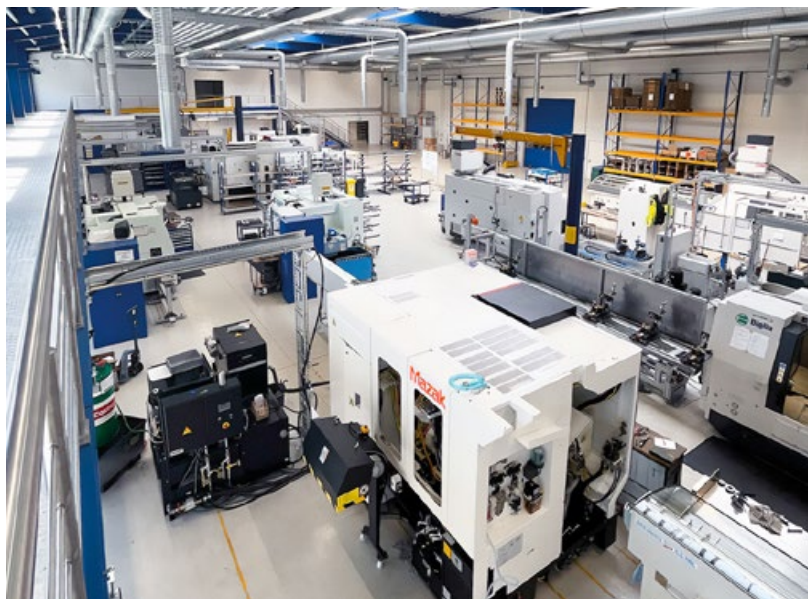
Die neu aufgestellte Linear-technik-Produktion von Rodriguez mit dem leistungsstarken CNC-Drehzentrum von Mazak.
