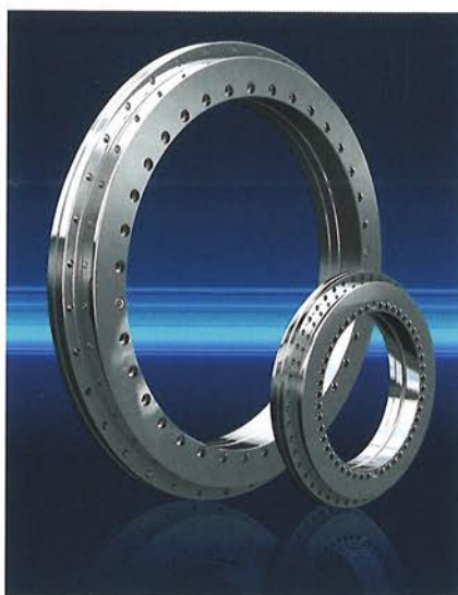
Die Standardausführung der Axial-Radial-Zylinderrollenlager besteht aus einem geschmiedeten, L-förmigen Innenring, einem Außenring, zwei Axialrollenlagern, einem Zylinderrollenlager und einer Axialscheibe (Bilder 1-3: Rodriguez GmbH/Unitec)
