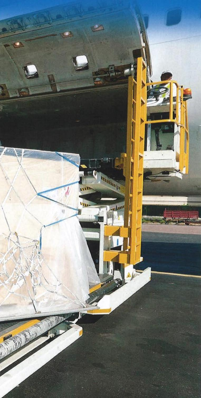
Überall wo schweres Ladegut leicht, präzise und mit minimalem Aufwand bewegt werden soll, können rundum bewegliche Kugelrollen helfen. Ein Anwendungsbeispiel ist die Frachtabfertigung in der Luftfahrt, wo Kugelrollen die einfache Bewegung von schweren Containern mit einem Gewicht von bis zu 10 Tonnen ermöglichen.
