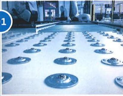
**01** Kugeldecks, die mit Air Cargo Units ausgestattet sind, haben eine sehr hohe Tragfähigkeit
