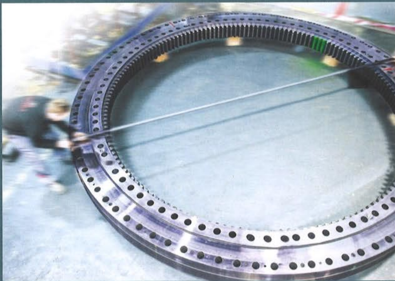
Der Außendurchmesser von Großwälzlagern kann bei Rodriguez bis zu 6.100 mm betragen. Foto: Rodriguez
