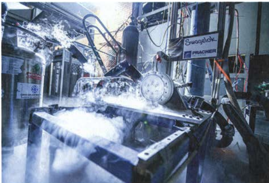
◀ Im Prüfstand für die Tests des Versorgungssystems der Brennkammer sind Profilschienen und Präzisionslaufwagen von Rodriguez verbaut.
