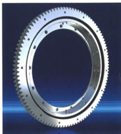
Die außenverzahnten Kugeldrehverbindungen sind mit einem Ritzelantrieb ausgestattet und erlauben es, die großen Scherenhebebühnen zu drehen. Bild: Rodriguez
