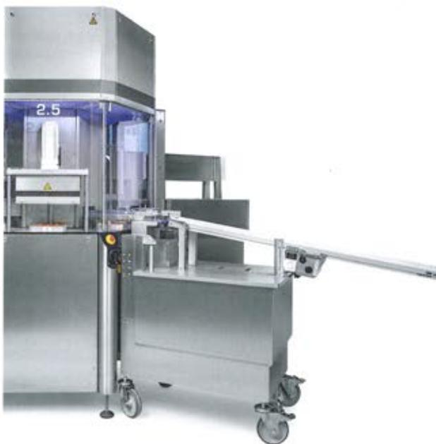
Auf Basis der Plattform LAP-C realisierte GTE-engineering eine vollautomatische Montage- und Verpackungsmaschine für einen Hersteller von Spritzen.
