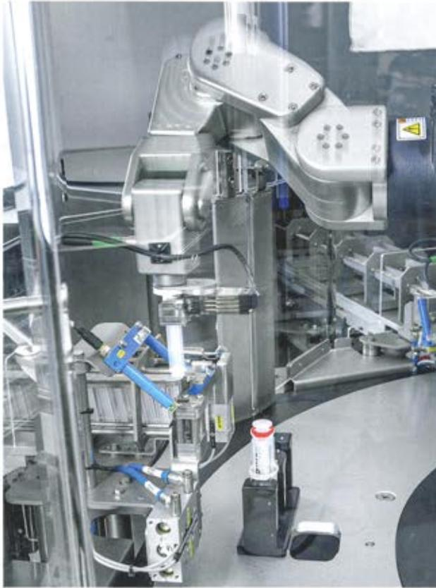
Eine kundenspezifische Kugeldrehverbindung von Rodriguez ermöglicht die Drehbewegung, die die Produkte zu den verschiedenen Stationen transportiert.
