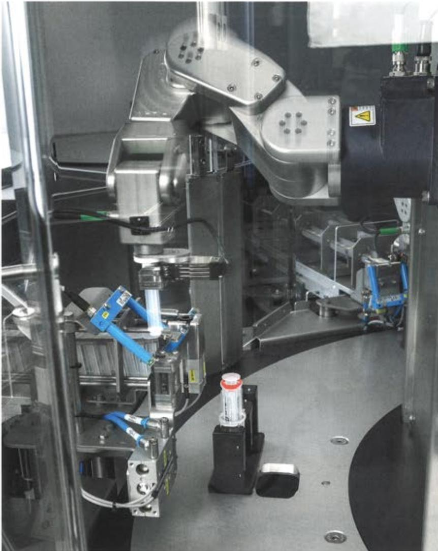
**Bild 3** Eine kundenspezifische Kugeldrehverbindung von Rodriguez ermöglicht die Drehbewegung, die die Produkte des Kunden zu den verschiedenen Stationen transportiert. (Bild: GTE-engineering)
