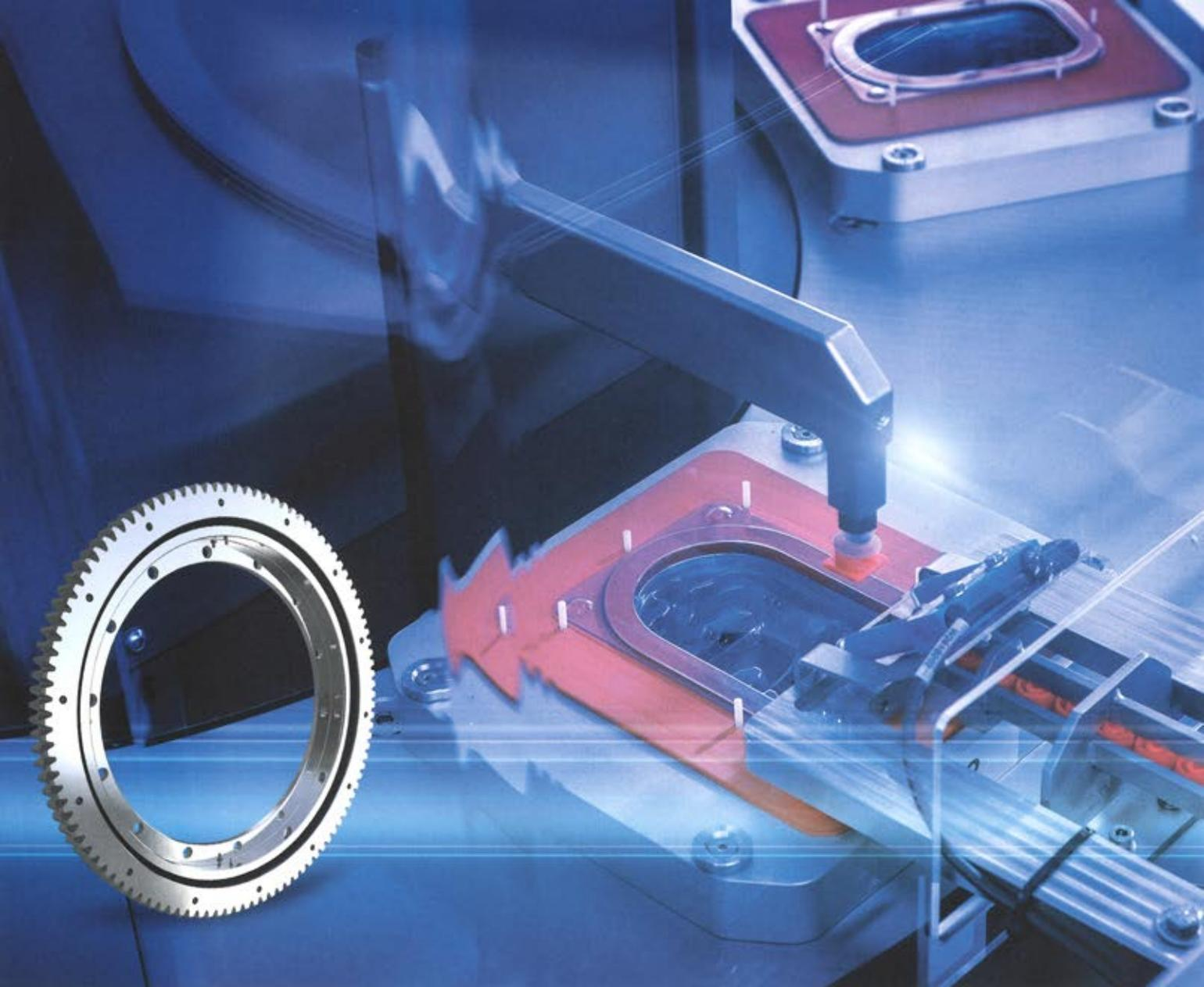
**Bild 1** In der standardisierten Plattform LAP-C des Unternehmens GTE-engineering kommen kundenspezifische Kugeldrehverbindung von Rodriguez zum Einsatz. (Bild: GTE-Engineering/Rodriguez)
