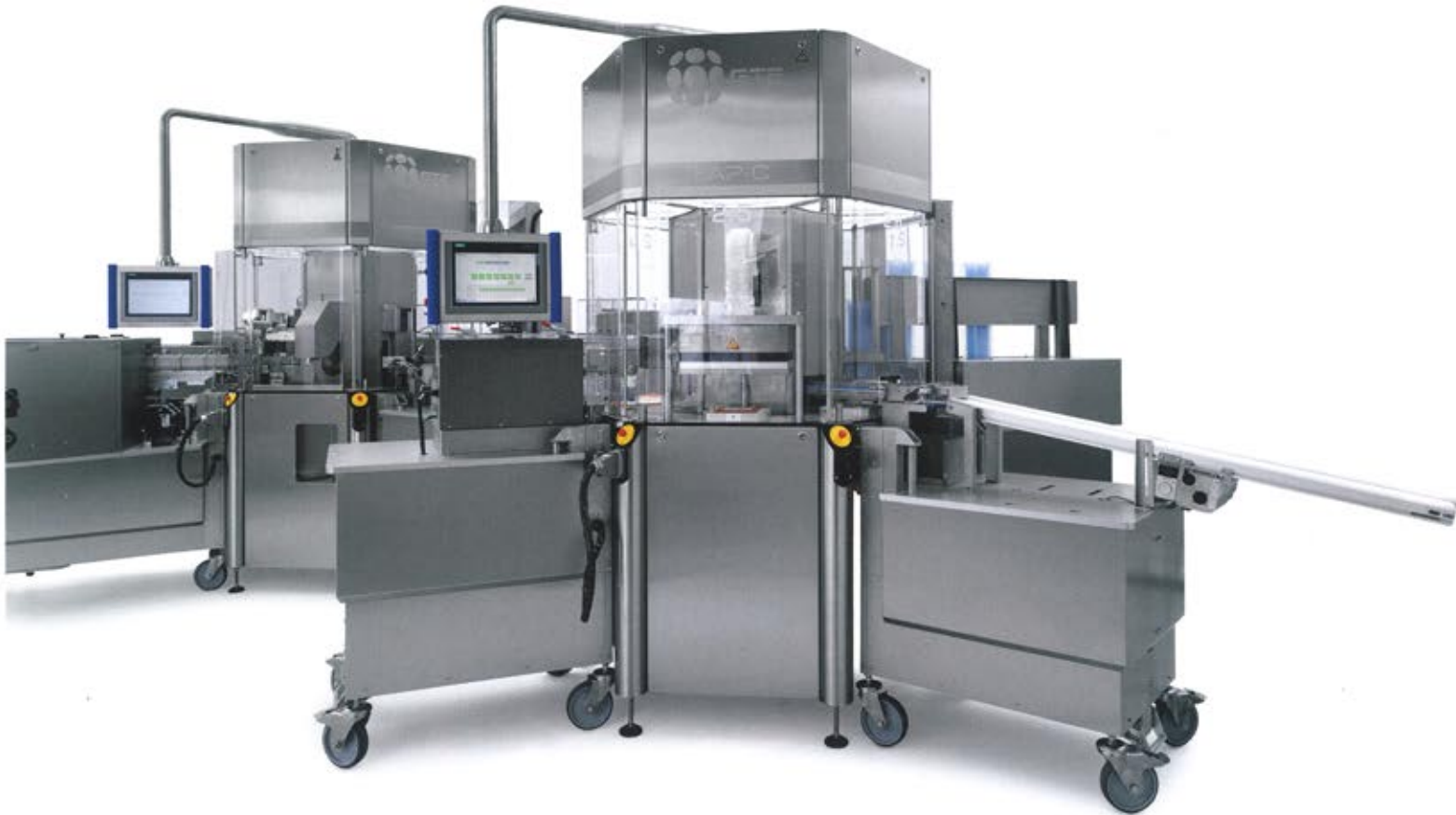
Op basis van het platform LAP-C realiserde GTE-engineering een volledig automatische montage- en verpakkingmachine voor een fabrikant van sproeiers
