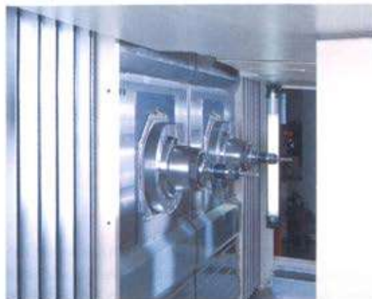
Im vertikalen Werkzeug-Magazin des doppelspindigen Bearbeitungszentrums der Firma Schmid sorgt ein Vierpunktlager von Rodriguez für die Drehung.
