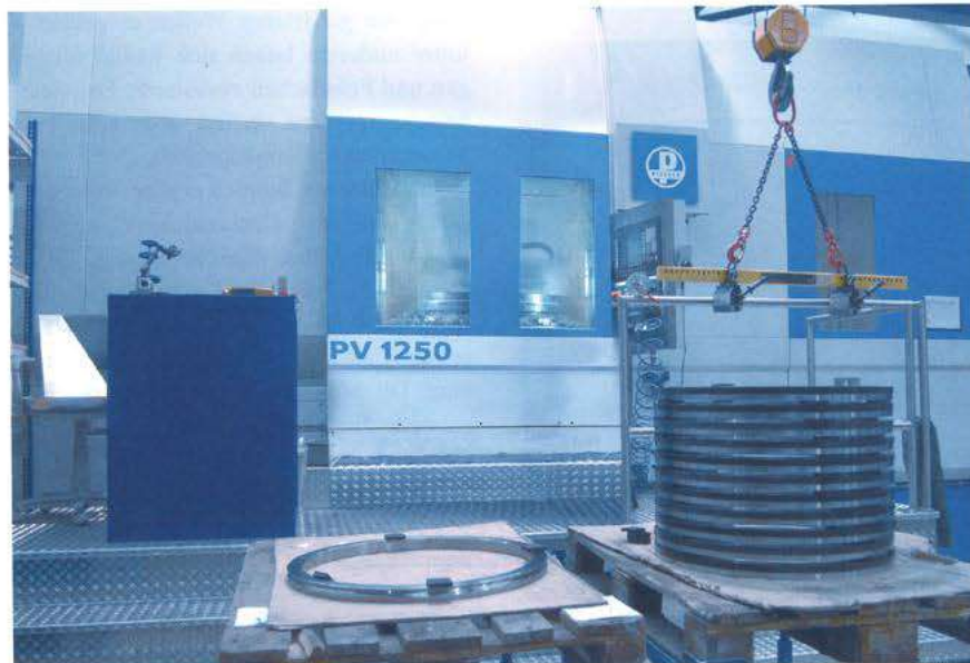
Bild 2. Im Bereich der Präzisionslager werden Kugeldrehverbindungen mit Außendurchmessern bis zu 1400 mm gefertigt. Bild: Rodriguez
