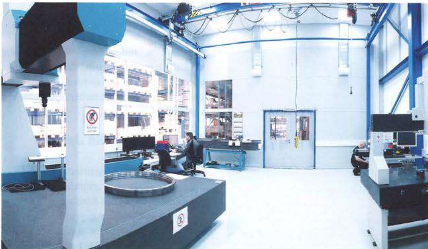
Bild 5. Im Messraum lassen sich die geforderten Toleranzen von Präzisionslagern und Lineartechnik im \mu\text{m} -Bereich prüfen. Bild: Rodriguez
