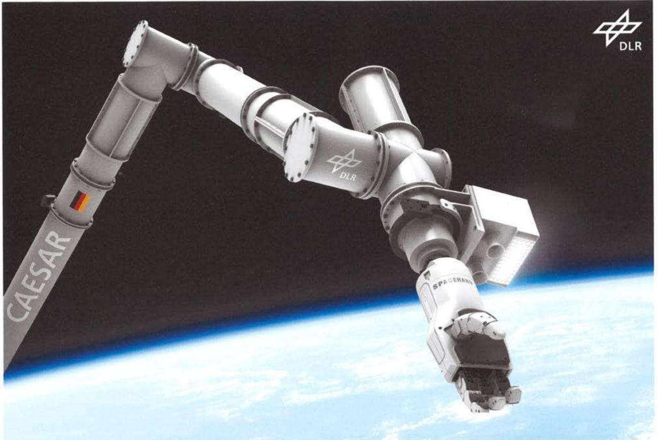
**Bild 1** Der Roboterarm CAESAR wurde vom DLR entwickelt und dient auf der Außenseite der ISS dazu, Serviceaufgaben für wissenschaftliche und technische Experimenten zu übernehmen. Bild: DLR
