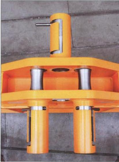
Die Traverse ist wahlweise für die Verwendung von Einfach- und Doppelhaken geeignet.
