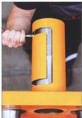
Die „duale Aufnahme“ der Traverse lässt sich mittels exzentrischer Schiebelbolzen manuell verriegeln.
