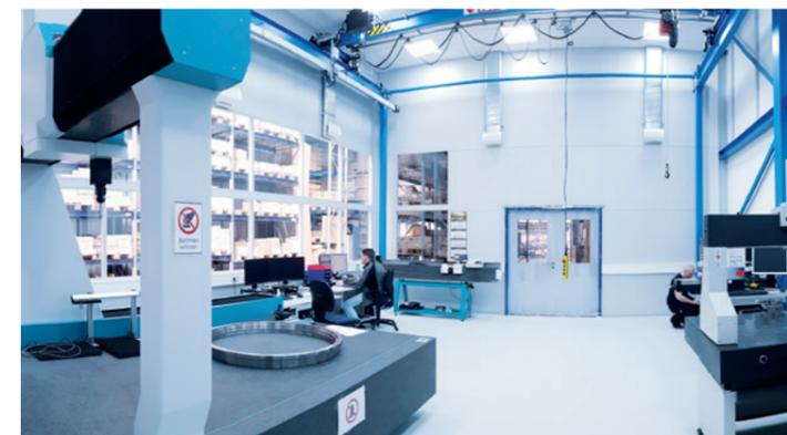
Diese Mittel ermöglichen es dem Eschweiler Spezialisten, die Maßhaltigkeit zum Beispiel von bearbeiteten Wellen und Kugelrollspindeln, aber auch von Frästeilen wie Lagergehäusen und Wellenunterstützungen zu prüfen. Abgesehen von einzelnen Komponenten lassen sich aber auch komplexe Bauteile kontrollieren: Wichtig ist dies unter anderem bei den kundenspezifischen Systemlösungen.
