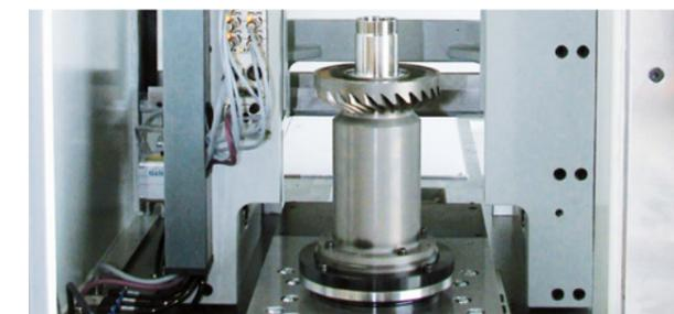
Die speziell für rotationssymmetrische Geometrien entwickelte Spanntechnik in der Laserschweißzelle lagert auf einer eigens dafür entwickelten Lagerlösung.
