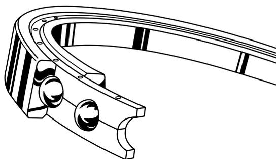
Der Vollringkäfig für Lagertyp A ist aus einem Stück hergestellt und wird mit den Kugeln um den inneren Ring herum platziert, anschließend wird der äußere Ring erwärmt und über die Kugeln gezogen. Diese Montagemethode erlaubt die Verwendung von mehr Kugeln als bei den Lagertypen X und C. Standardmaterialien sind hier Messing oder Kunststoffe wie z.B. verstärktes Nylon. Zusätzlich sind Ausführungen in Phenol-Laminat, Edelstahl und Aluminium lieferbar.
