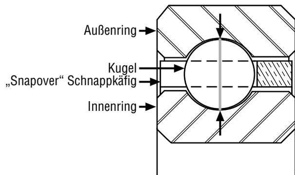
Obwohl das Lager Typ C vorrangig für Anwendungen mit Radiallasten ausgelegt wurde, kann es bis zu einem bestimmten Grad auch Axiallasten in beide Richtungen aufnehmen. Sind die Axiallasten jedoch von Bedeutung, sollte für solche Anwendungen ein Schrägkugellager in Betracht gezogen werden.
