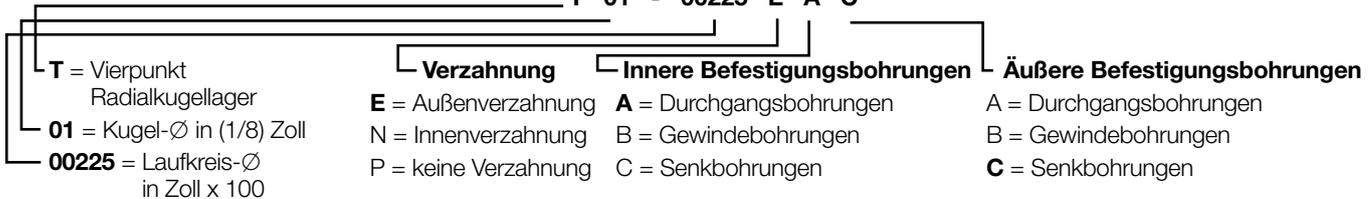
Die Montagebohrungen haben Ø 3,45 mm Durchgangsbohrungen, Gewindebohrungen oder Senkkopfbohrungen. Die Verzahnung hat 20° Eingriffswinkel mit Modul M 0,5.
