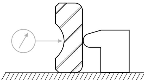
Das Radialspiel von REALI-SLIM® Lagern wird durch selektive Montage von Kugeln und Laufbahnen und anschließender Vermessung mittels spezieller für diesen Zweck konstruierter Prüflinien kontrolliert.
