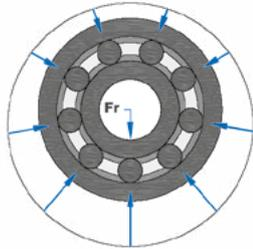
Dieses Radiallager hat eine sehr hohe Vorspannung. Alle Kugeln werden belastet, und die Last auf die untere Kugel ist genauso hoch wie bei dem Lager mit Spiel im ersten Beispiel.
