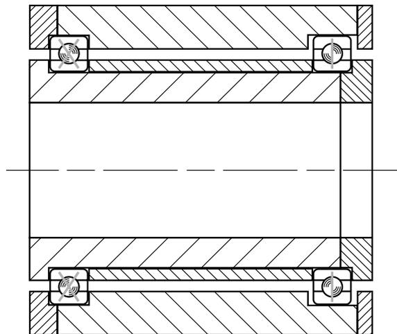
Für hohe Drehzahlen sind die Lager des Typs A (Bild 3-20), welche eine optimale Einstellung des Lagerspiels ermöglichen, besser geeignet.
