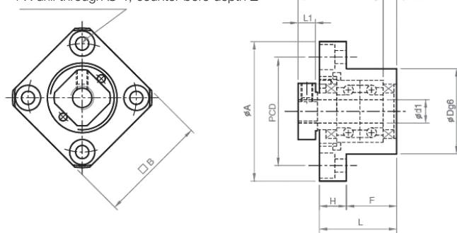
**FF** Flanschlager für Loslagerseite
