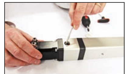
Motorkupplungsschrauben anziehen und Dichtstopfen einsetzen
