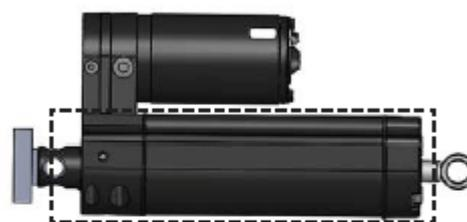
Versuchen Sie nicht, H-Track-Aktuatoren am Schutzrohr zu befestigen. Das Rohr ist nicht auf die zur Rohrmontage erforderlichen Kräfte ausgelegt.
