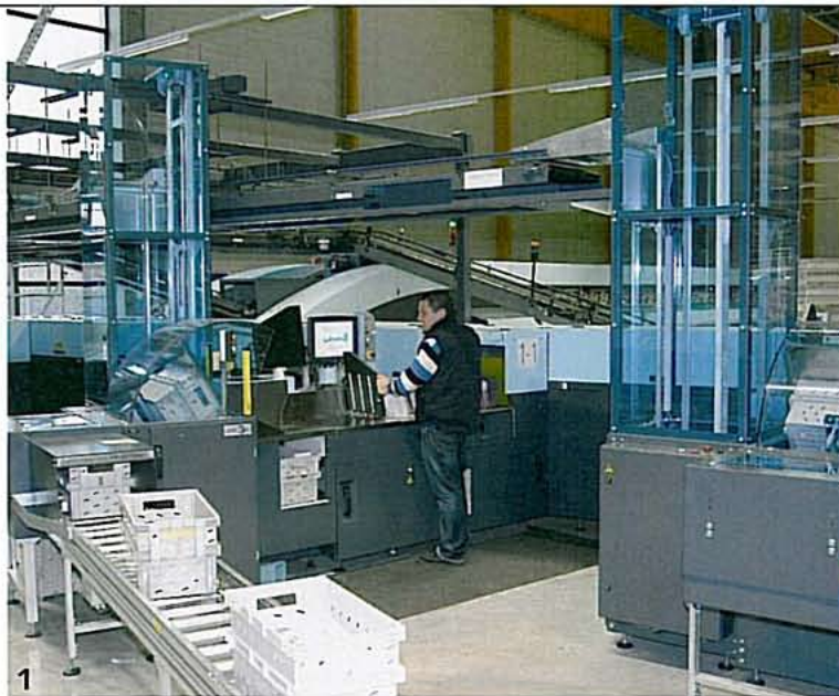
1 In der Sortieranlage von Solystic werden Schriftstücke bis zu 32 Millimeter Höhe und bis zu zwei Kilo Gewicht verarbeitet.
